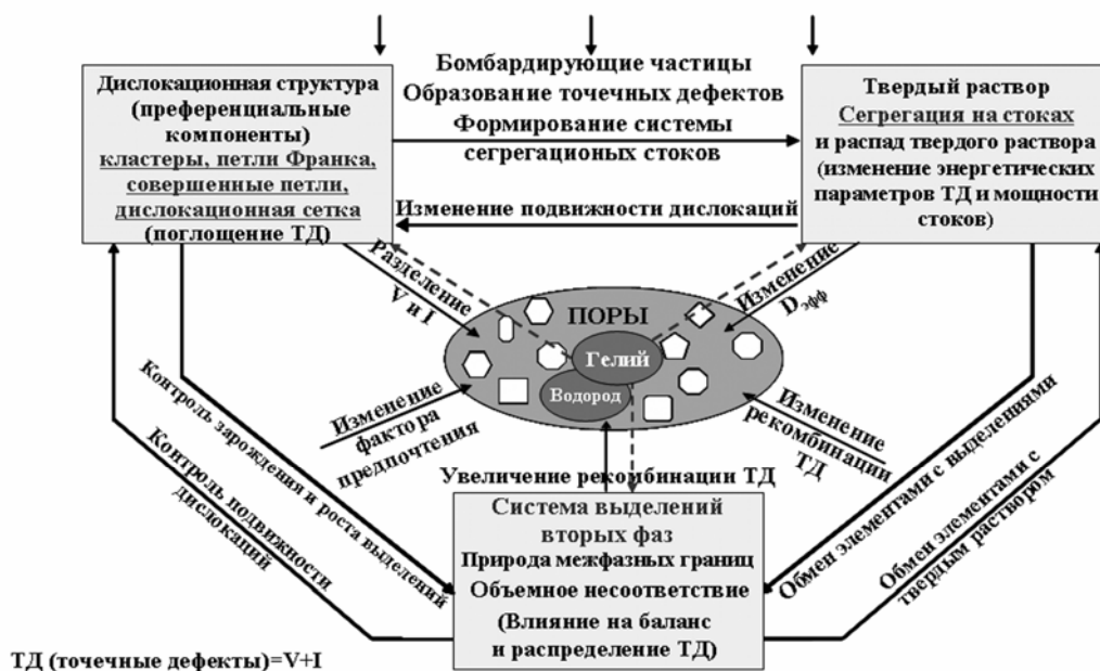
Рис. 7. Основные взаимосвязи в структуре нержавеющей сталей под облучением [2]
