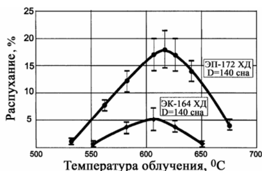
Рис. 11. Температурная зависимость распухания в аустенитных сталях (ЭП-172, ЭК-64) ( Cr^{3+} , D=140 сна)
